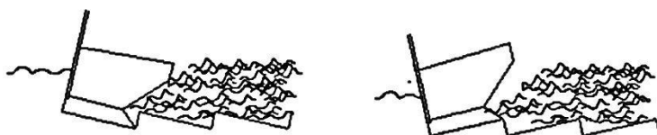
گاو آهن تراز عرضی نیست و خاک خوب شخم نخورده گف شیار ناصاف می باشد
