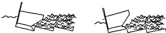
گاواهن تراز عرضی بسته و خاک خوب شخم نخورده کف شیار ناصاف می باشد
